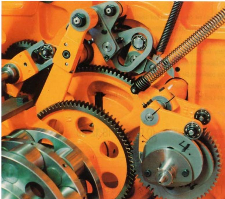
Die genaue Auslegung von Bewegungsabläufen ist für die Taktleistung von Maschinen von zentraler Bedeutung. Mechanische Kurven waren Servoantrieben hier bisher überlegen. Ein Software-Programm, das die Bewegungsverläufe von Servosteuerungen optimiert, verbessert deren Leistung.
